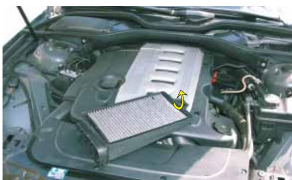
(PL) Wyciągnąć filtr z ramką, zużyty usunąć z ramki i zamontować nowy, czynności wykonać dla obu filtrów
